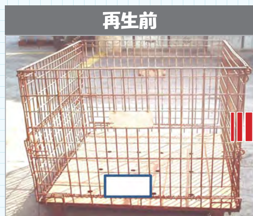
赤錆が発生して使用不可
